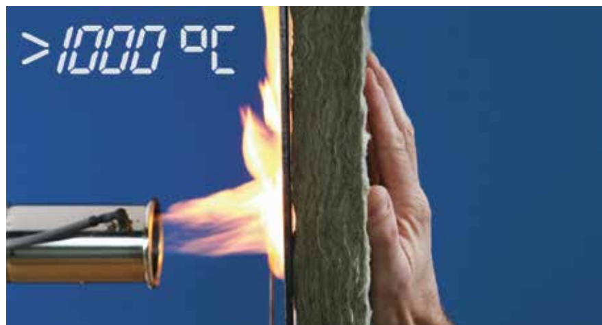
Steinwolle von Flumroc hat einen Schmelzpunkt von über 1000 °C.
