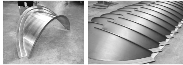
Beispiel: Verlegung einer Kurvenkehle mit rundem Anschluss.
