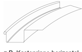
z.B. Kastenrinne horizontal Aussernungung mit Wulst und Einklebeschnekel mit oder ohne Neigung
