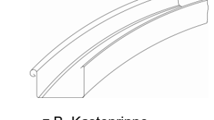
z.B. Kastenrinne horizontal Ausser- nungung mit Wulst und Wasserfalz nach DIN
